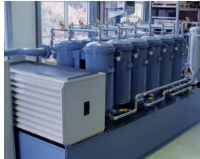
Zentralanlage für Schleiföle in der Hartmetall-Werkzeugfertigung für 15 Maschinen
